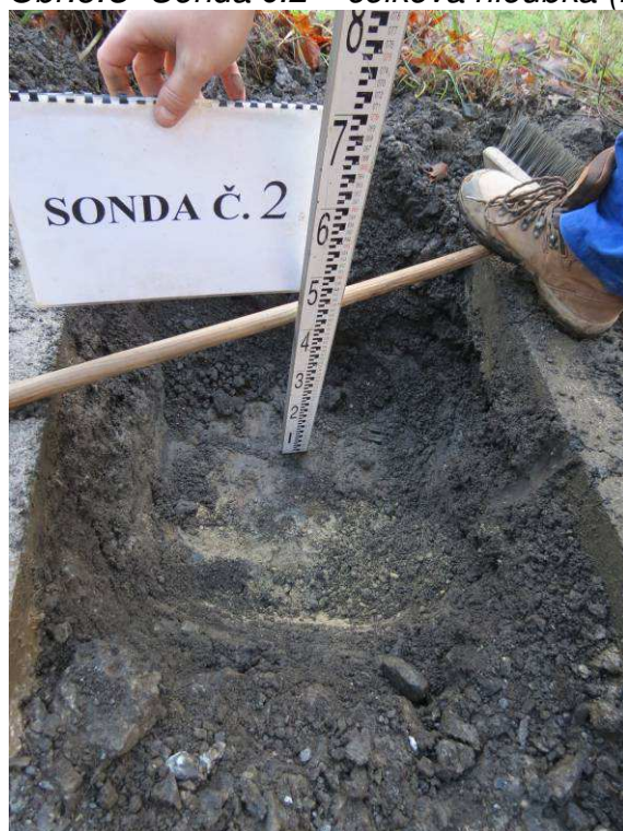
Obr.8.C Sonda č.2 – celková hloubka (rozšíření vozovky)
