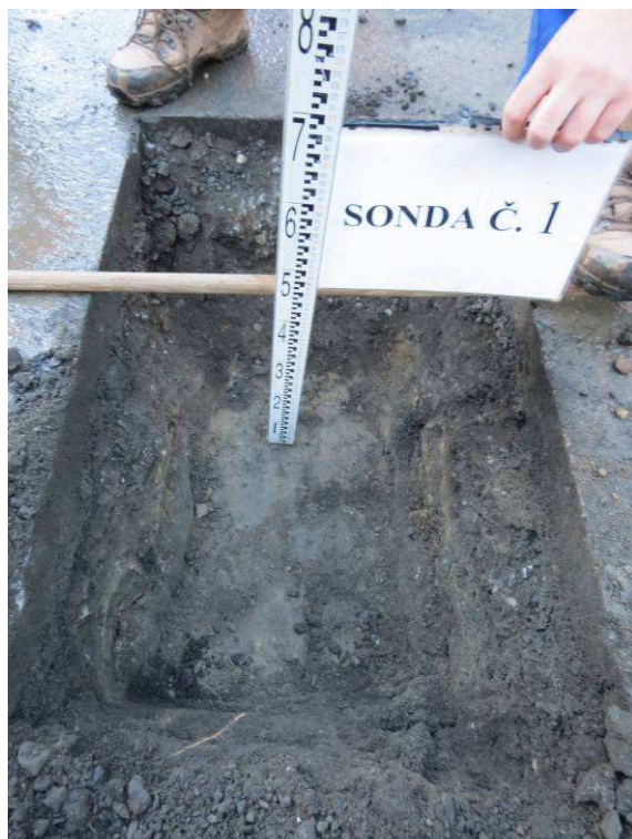
Obr.6.C Sonda č.1 – detail rozhraní konstrukcí
