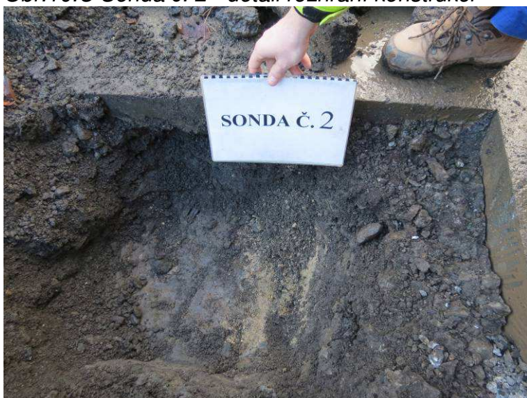
Obr.10.C Sonda č. 2 - detail rozhraní konstrukcí
