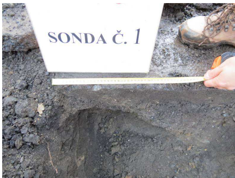
Obr.6.C Sonda č.1 – detail rozhraní konstrukcí
