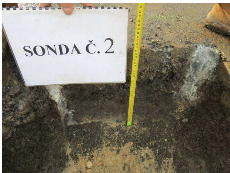
Obr.8.C Sonda č.2 – celková hloubka (rozšíření vozovky)
