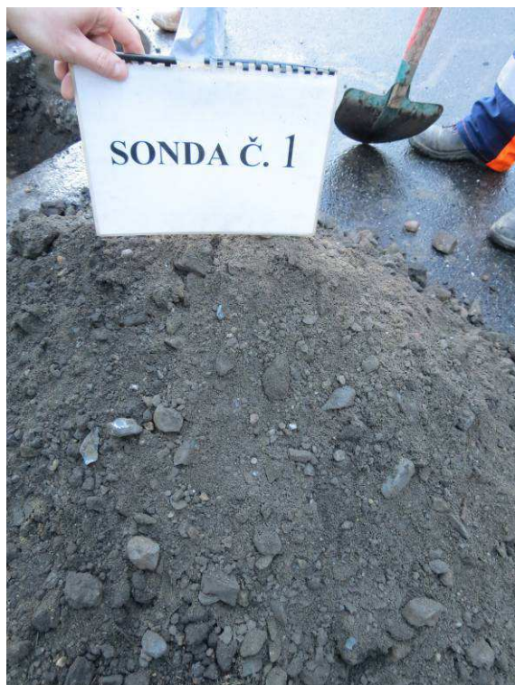
Obr.5.C Sonda č.1 – materiál konstrukční vrstvy
